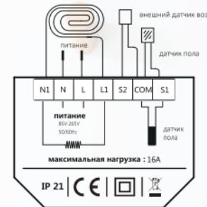
Выберите используемый датчик: датчик пола или датчик воздуха, или датчик пола и датчик воздуха вместе.
